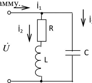
9. Дать определение резонанса напряжений: в каких цепях, при каких условиях, как проявляется? Определить ёмкость, которую нужно включить последовательно с катушкой  $R = 16 \text{ Ом}$ ,  $L = 158 \text{ мГн}$  заданной цепи, чтобы в ней наступил режим резонанса напряжений при частоте  $50 \text{ Гц}$ . Рассчитать ток, мощность в цепи, напряжение на катушке. Построить диаграмму напряжений.  $U = 10 \text{ В}$ .
