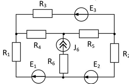
2. Методом наложения определить ток  $I_2$  в заданной цепи.  $J = 3,5 \text{ А}$ ,  $E_2 = 3 \text{ В}$ ,  $R_1 = R_5 = 2 \text{ Ом}$ ,  $R_2 = R_4 = 4 \text{ Ом}$ ,  $R_3 = 2 \text{ Ом}$
