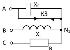
15. Рассчитать фазные напряжения и токи приемника, у которого  $R = X_L = X_C = 10 \text{ Ом}$ , если он подключен к несимметричному источнику с  $\dot{U}_A = 100 \text{ В}$ ,  $\dot{U}_B = 100e^{j90^\circ} \text{ В}$ ,  $\dot{U}_C = 141e^{j135^\circ} \text{ В}$ . Построить топографическую диаграмму напряжений и векторную диаграмму токов, рассчитать активную мощность.
