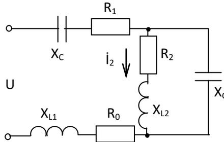
8. Дать определение резонанса токов: в каких цепях, при каких условиях, как проявляется? Рассчитать величину ёмкости, при которой в заданной цепи наступает резонанс токов, если  $R = 11,2 \text{ Ом}$ ,  $L = 40 \text{ мГн}$ ,  $f = 50 \text{ Гц}$ . Определить токи  $I_1, I_2, I_3$ , если  $U = 10 \text{ В}$ . Построить векторную диаграмму.
