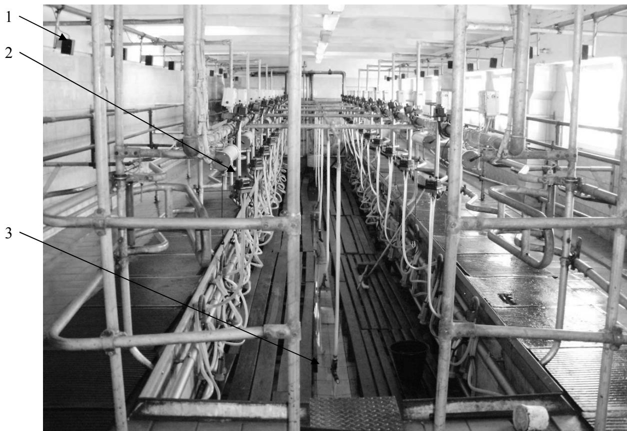
1 - датчик, улавливающий респондер; 2 – дисплей; 3 – штуцер
